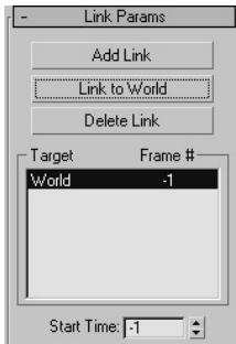
Rysunek 7.95. Po przyłączeniu obiektu do globalnego układu współrzędnych ustaw wartość parametru Start Time na -1
